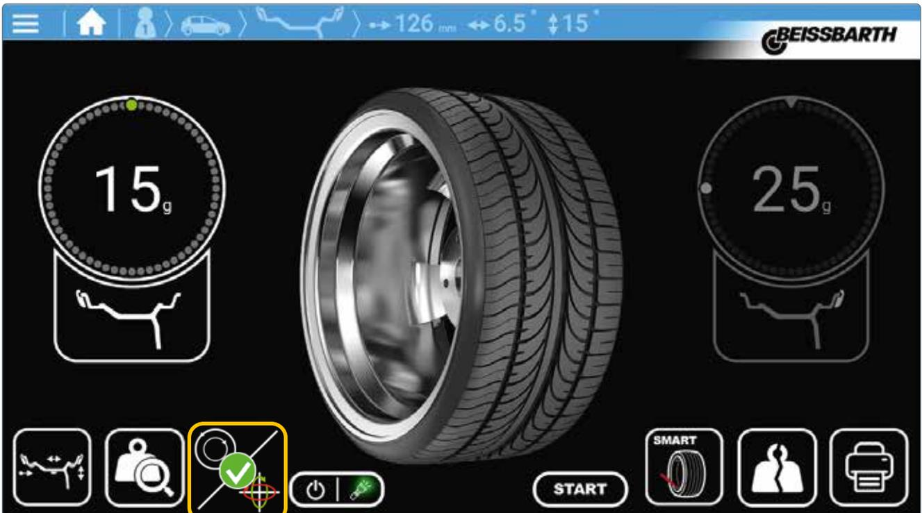
Jedes Rad wird auf Abweichung vom Mittelpunkt geprüft (Exzentrizität)
