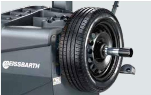
Flansch: pneumatische Radaufspannung
