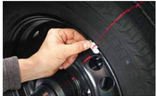
**Linienlaser\*** zur exakten Positionierung der Schlaggewichte an Stahlfelgen außen
