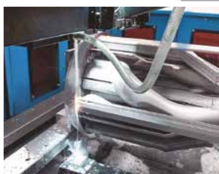
Bei der additiven Fertigung entstehen komplexe Bauteile auf einer Metallplatte, die anschließend vom Bauteil getrennt werden muss (NeoSpark 500 B Continental Engineering Services)
