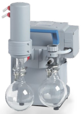
MZ 2C NT +AK +EK Chemie-Membranpumpe 2.0 m 3 /h, 7 mbar Vakuumananschluss: Schlauchwelle DN 8-10
