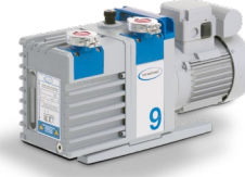
RZ 9 Drehschieberpumpe 8.9 m 3 /h, 2 x 10 -3 mbar Vakuumschluss: Kleinflansch DN 25
