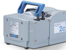
ME 2C NT Chemie-Membranpumpe 2.1 m 3 /h, 70 mbar Vakuumschluss: Schlauchwelle DN 8-10 (nicht abschraubbar)
