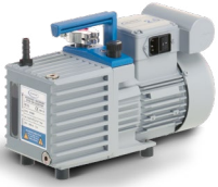
RZ 2.5 Drehschieberpumpe 2.3 m 3 /h, 2 x 10 -3 mbar Vakuumschluss: Kleinflansch DN 16
