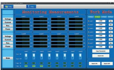
Hierbei können die elektronischen Lasten als Gesamtlast verwendet werden oder auch unabhängig voneinander eingestellt werden. Die Ansteuerung erfolgt über eine digitale Schnittstelle RS232, RS485 oder USB (Option).
