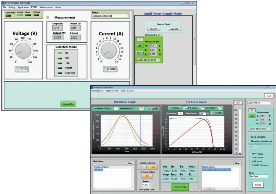
Die Lab View-programmierte Software kann sämtliche Geräte der Baureihen LAB/HP und LAB/SMP über alle vorhandenen Schnittstellen ansteuern. Die Bediensoftware wurde so konzipiert, dass eine vollständige Fernbedienung der Geräte möglich wird. Sie erlaubt nicht nur, sämtliche Betriebsmodi und Einstellwerte vom Computer aus einzustellen, sondern auch komplette Prüf- und Testabläufe am Rechner zu erstellen und auf jedes beliebige Gerät zu übertragen - per Internet auch rund um den Globus.
