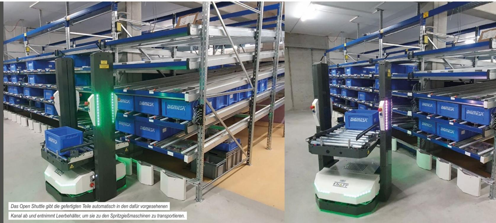
Das Open Shuttle gibt die gefertigten Teile automatisch in den dafür vorgesehenen
