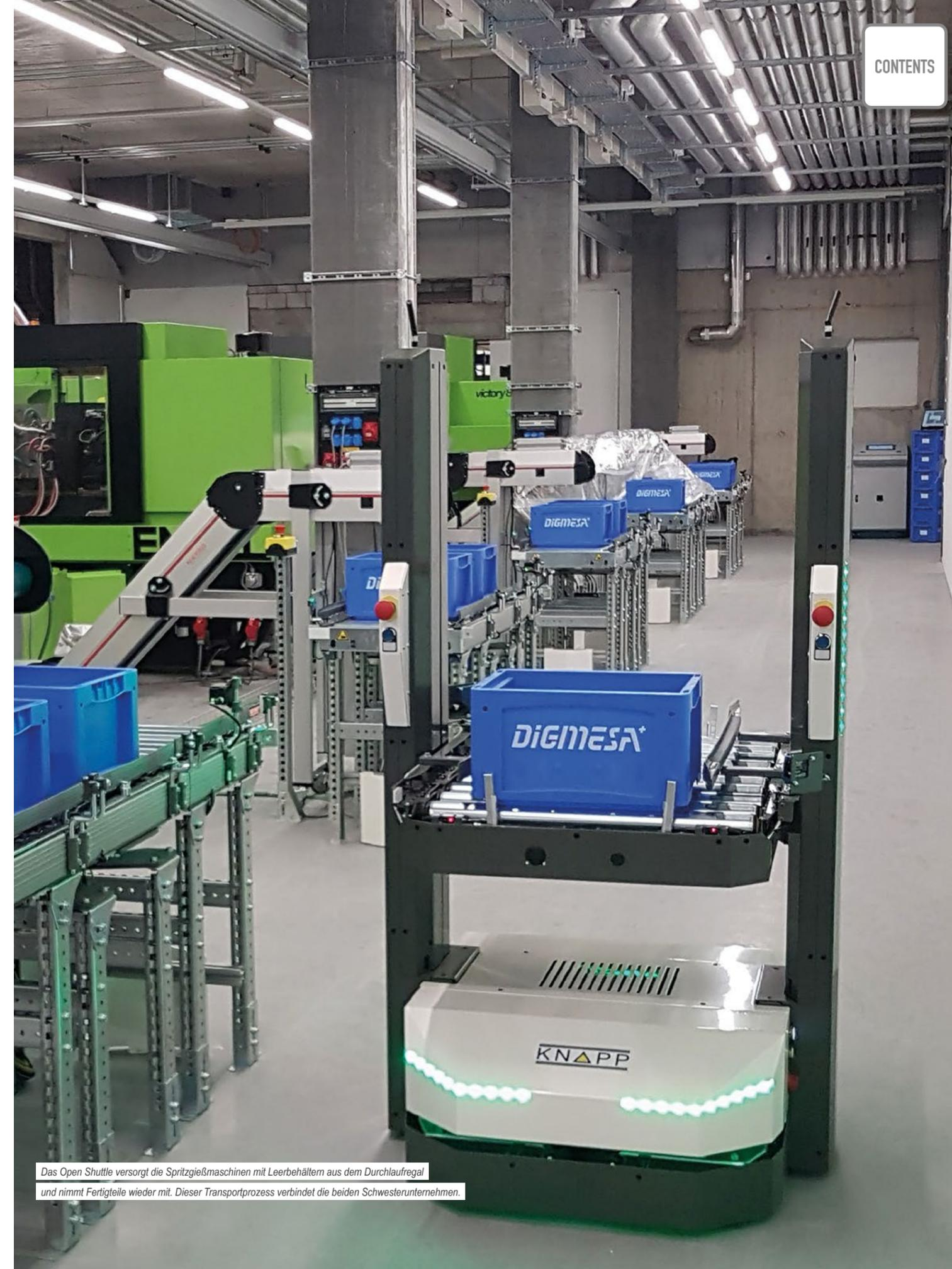
Das Open Shuttle versorgt die Spritzgießmaschinen mit Leerbehältern aus dem Durchlaufregal und nimmt Fertigteile wieder mit. Dieser Transportprozess verbindet die beiden Schwesterunternehmen.
