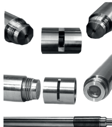
Oben/Mitte: Transmissionssondenpaar mit Abstandshalter und Einzelfaser/MicroBundle-Faser. Unten: Transmissionssonde mit Gewinde für den Einsatz im Extruder
