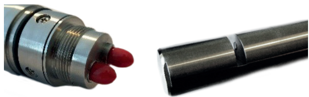
Transmissionssonde, links: Faseranschluss; rechts: Messspalt mit 2 mm OPL
