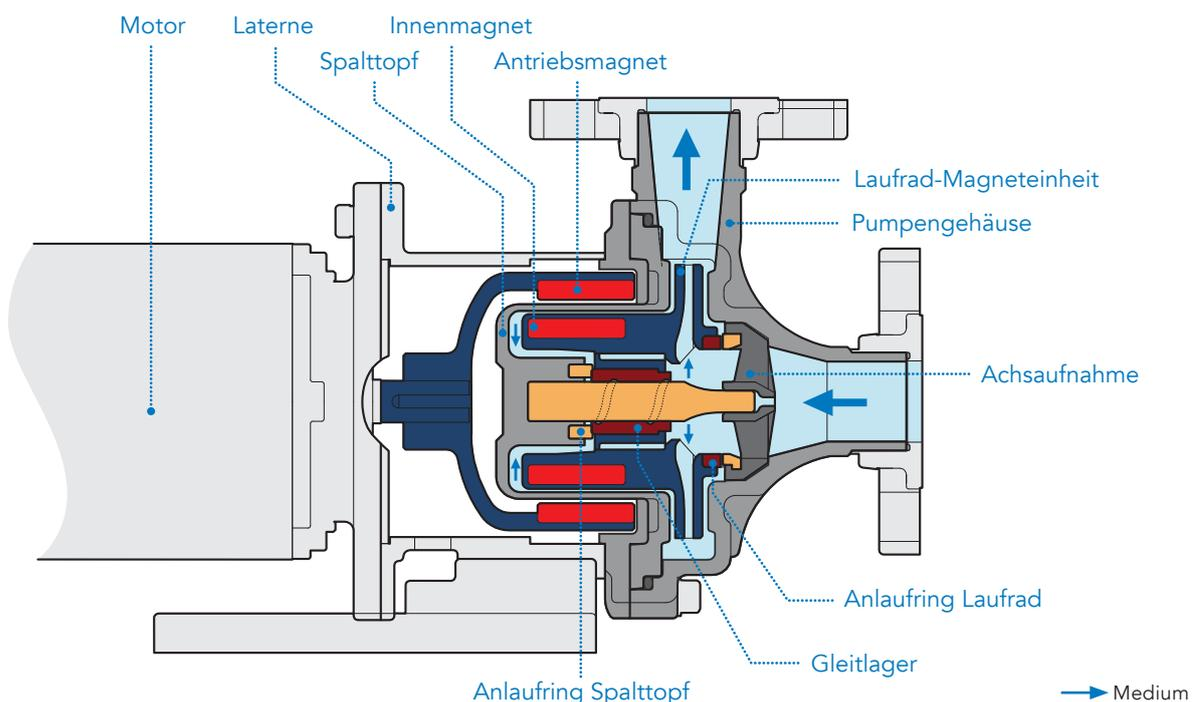
**Einfacher und robuster Aufbau im Baukastenprinzip:**
