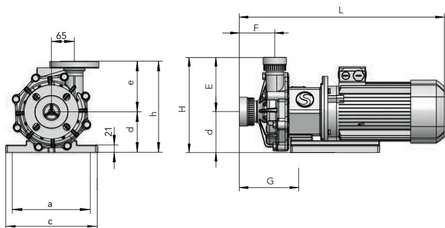
Abb.: MA BG6 mit Motoren bis 2,2kW
