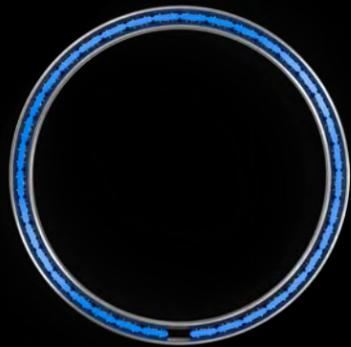
Franke Lagerelemente vom Typ LER eignen sich für mittlere Drehgeschwindigkeiten und Genauigkeiten. Sie überzeugen durch leichten Lauf, hohe Dynamik und kompakten Einbauraum. Durch die geraden Anlageflächen ergibt sich eine einfache Integration in die umschließende Konstruktion sowie eine hohe Steifigkeit.
