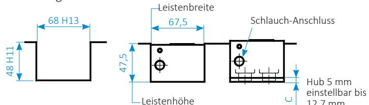
Spezielle Abmessungen von Nuten und Rollen für Geschwindigkeiten über 100 mm/s auf Anfrage.
