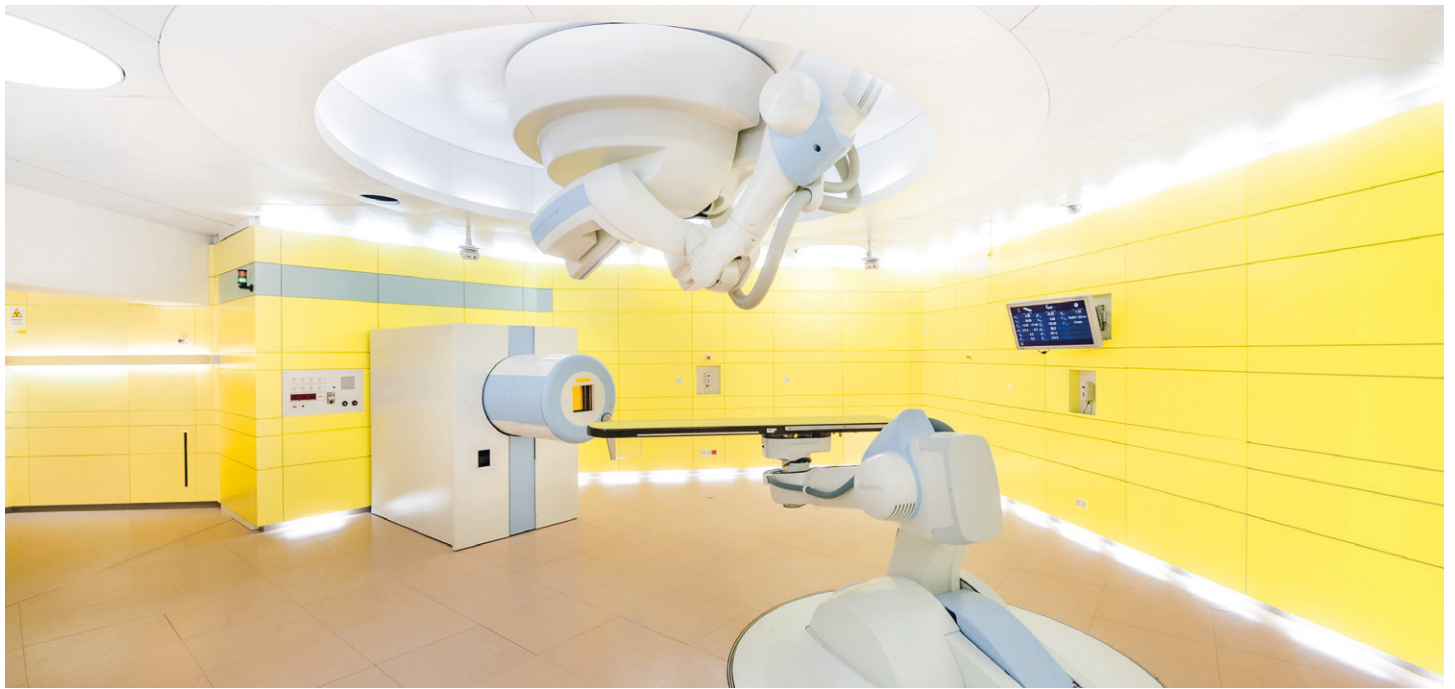
Abb.1: Behandlungstisch mit computergesteuertem Roboter im MIT
