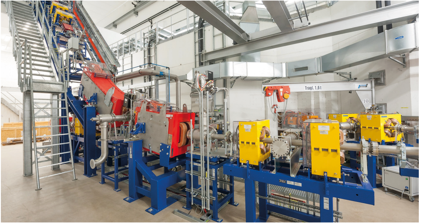
Abb. 4: Strahlführungssystem zum 45°-Behandlungsplatz am MIT, ausgestattet mit Lösungen von Pfeiffer Vacuum.
