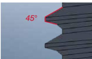
*Der asymmetrische Flankenwinkel von 45° bewirkt eine geringere Materialverdrängung als herkömmliche 60° Gewinde und ermöglicht eine hohe Festigkeit der Verbindung.*
