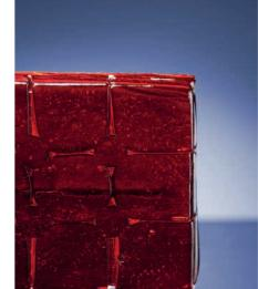
Gelartige Materialien Gele durchlaufen Sol-Gel-Übergänge als Funktion der Temperatur, der Zusammensetzung, des Lösungsaustauschs mit der Umgebung und anderer externer Parameter. Zur Bestimmung des Sol-Gel-Übergangs in optisch aktiven Proben (z. B. Gelatine) kann das MCP mit der automatischen Peltier-Temperierung für eine präzise schrittweise Erwärmung im Umfeld der Übergangstemperatur des Produkts verwendet werden.
