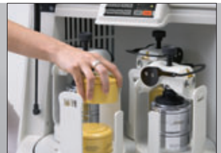
Besonders zeitsparend: gleichzeitige Mahlung von bis zu 8 Proben
