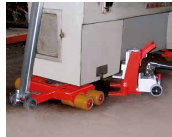
Kugelgelagerte Rollen garantieren einen leichten Lauf.
