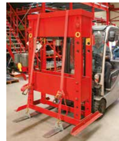
Ladungssicherung mit Gabelklemmen und Spanngurten
