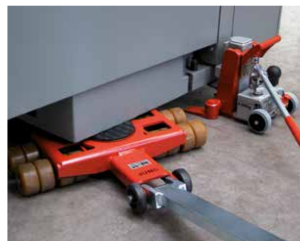
Kugelgelagerte Rollen garantieren einen leichten Lauf.
