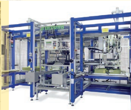
Verschrauben eines Kühlergrills
