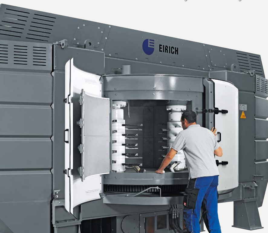
Mischer Typ R16W mit ausgefahrenen Werkzeugen
