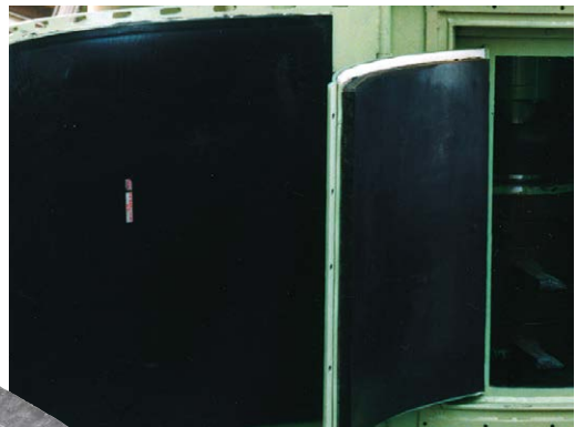
Mischbehälter mit Gummibelag
