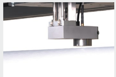
Berührungslose Inline-Dickenmessung von Folien
