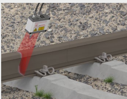
Vermessung der Schienen-Innenseite
