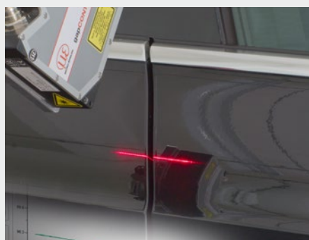
Spalt-/Bündigkeitsmessung an Karosserieteilen
