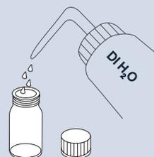
**Spülen** Sie die Küvetten nach jeder Messung gründlich mit entionisiertem Wasser. Reinigen Sie mit Laborreinigungsmitteln und spülen Sie mit entionisiertem Wasser nach. Starke Verunreinigungen mit 1:1 HCl und mehrfachem Spülen säubern.
