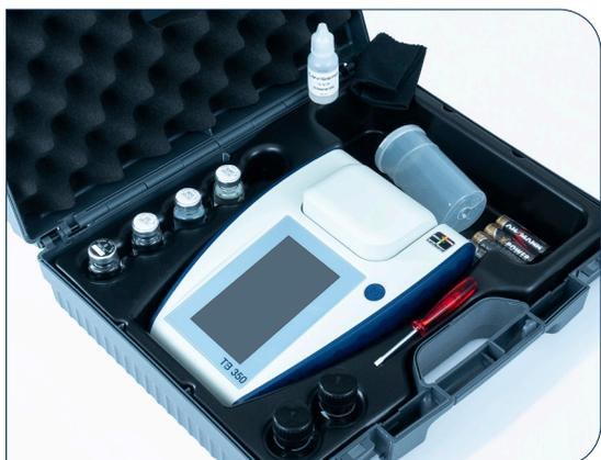
Tragbar im Koffer oder an einem festen Arbeitsplatz: Das Trübungsmessgerät TB350 ist ideal für den mobilen Einsatz vor Ort, z. B. für die Überwachung von Wasserverteilungssystemen, und für Labore, die eine Vielzahl von Proben untersuchen.
