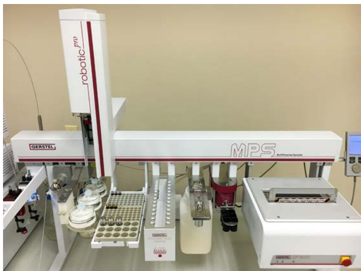
Verwendeter MPS-robotic-pro-Autosampler ausgestattet mit GERSTEL-QuickMix, CF-200 Zentrifuge, SPE- und Filtrations-einheit für die umfangreiche Vorbereitung von Eiprobe zwecks Bestimmung von Antibiotikarückständen. (Foto: GERSTEL)
