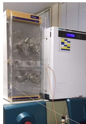
Effiziente LC/MS-Routineanalytik: „MayLab MatrixEX NG“ (New Generation) installiert auf einem Massenspektrometer.
