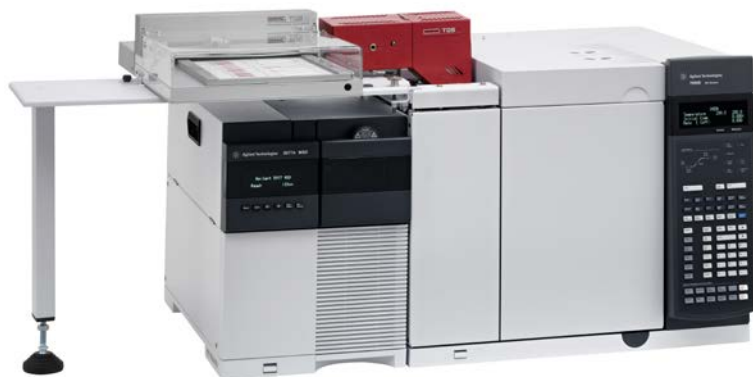
GC/MS-System von Agilent Technologies, ausgestattet mit einem GERSTEL-TDS und -TDSA-Sampler.
