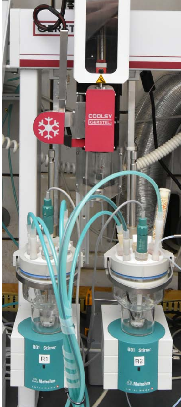
Zur Säure- und Wasserbestimmung wurden im Bereich des MPS zwei Titratoren integriert. Dr. Manfred Schwarzer fand eine Lösung, die Software der Titratoren mit der GERSTEL-MAESTRO-Software zu verbinden.
