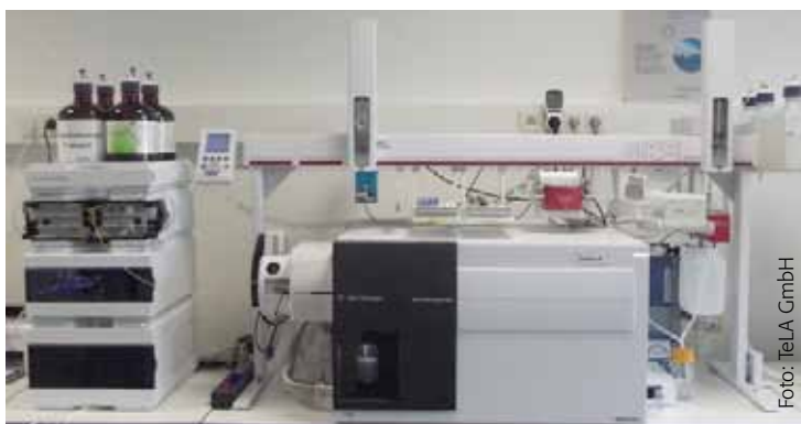
Für die Bestimmung der Pyrrolizidinalkaloide wurde eine Gerätekombination, bestehend aus einem MultiPurposeSampler (GERSTEL-MPS), konfiguriert für die automatisierte Ausführung der SPE, in Verbindung mit einem LC-MS/MS-System von Agilent Technologies (1290er HPLC mit 6495 Triple-Quadrupol), verwendet.
