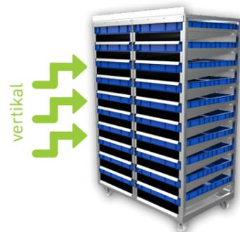
Bei schüttfähigen Produkten wird die horizontal einströmende Luft vertikal durch die Hordenwannen geführt und anschließend horizontal wieder abgeführt. Nur dadurch ist eine homogene Trocknung gewährleistet.
