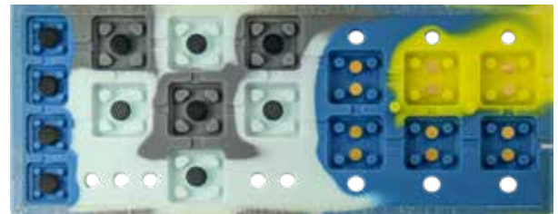
Silikonschaltmatte mit Kontaktpillen aus Kohlen und Gold und Stabilisatoren
