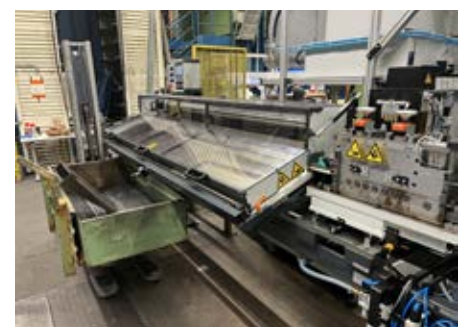
Die ankommenden Teile werden von dem Anschlagssystem abgebremst und fallen über eine Rutsche in den Teilebehälter.
