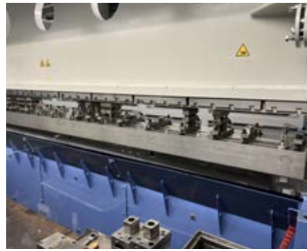
Die Hubzahlen der Stanzmaschine konnten auf bis zu 60 Hub bei Maximallänge erhöht werden.
