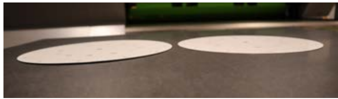
Zifferblätter für namhaften Luxusuhrenhersteller: Links vor dem Richten – rechts nach dem Richten
