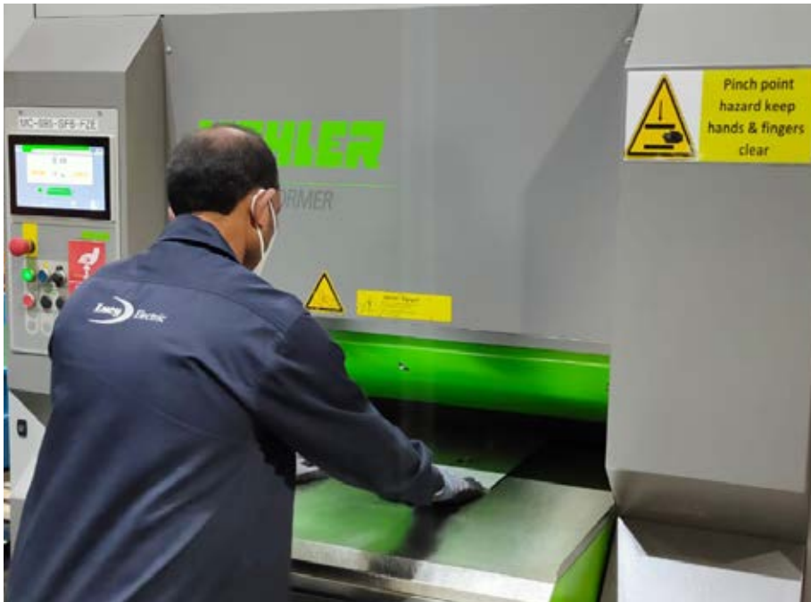
Auf der Teilerichtmaschine 45P900 nimmt das Richten von Teilen nur wenige Sekunden in Anspruch. Bild: Lucy
