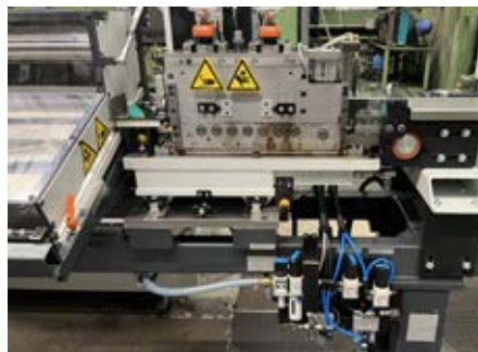
Ein Nachrichtwerk mit 13 Richtwalzen sorgt nach dem Stanzen für optimale Richtergebnisse.
