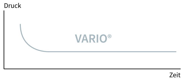
Abb. 20: Punktgenaue Regelung durch Drehzahlsteuerung
