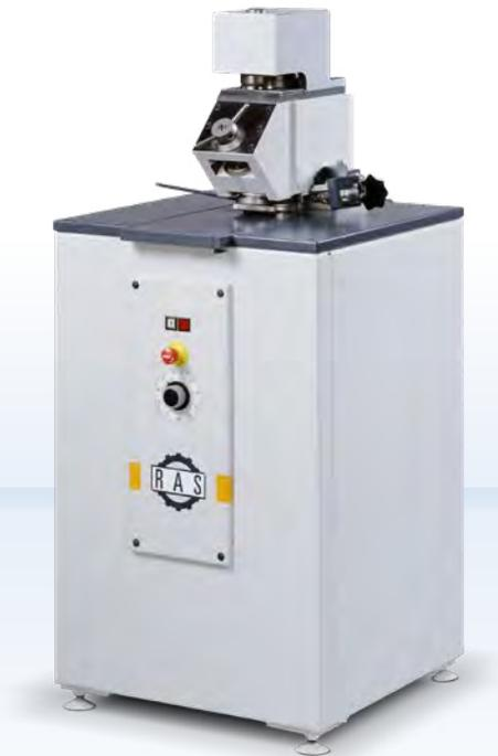
Die Bördelmaschine RAS 21.20 ist ein bewährter Helfer in der Lüftungsindustrie, wenn Bogensegmente für Luftkanäle hergestellt werden. Die Umformrollen stellen die Borde an Bogensegmenten auf 90 Grad hoch und bereitet die Luftkanalkomponenten für die Pittsburgh- oder Schnappfalz-Verbindungen vor.
