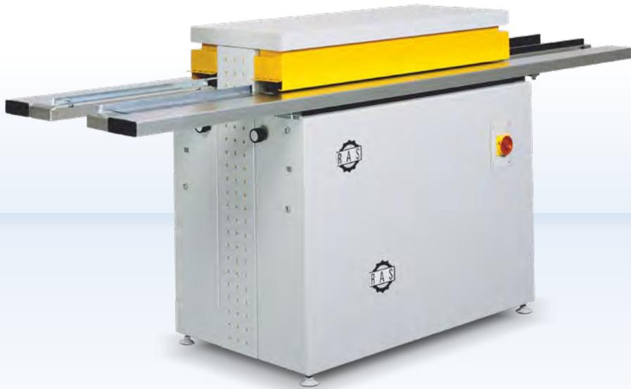
Der SpeedySeamer RAS 22.07 mit sieben Umformstationen ist ein multifunktionaler und kostengünstiger Alleskönner zur Herstellung von Falzen für die Lüftungsindustrie. Die hochwertige Maschinenvariante RAS 22.09 bringt die Falzverbindungen auf neun Umformstationen in Bestform.
