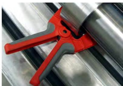
Die Haltezange reduziert eine Durchbiegung der Wellen.
