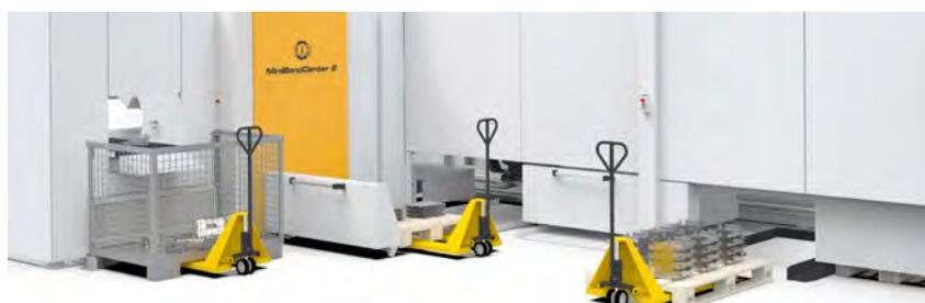
Die Fertigteil-Entnahme erfolgt entweder durch eine Gitterbox am Auslaufband oder an zwei Stapelplätzen, die nach öffnen pneumatischer Hubtore bequem zugänglich sind. Für die Platinen stehen zwei herausfahrbare Paletteneinheiten zur Verfügung.
