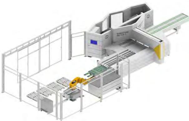
Multibend-Center mit Roboterbeladung. Bereitstellung der Platinen auf Europaletten. Der Roboter kann die Platinen auch wenden. Kein Programmieren/Teachen des intelligenten Roboters erforderlich.
