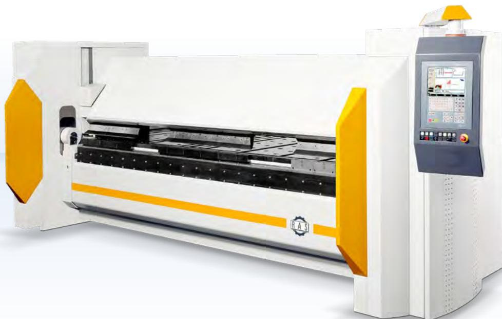
Gerade Biegungen sind unentbehrlich für perfekte Biegeteile. Eine robuste Maschinenkonstruktion und eine wuchtige Biegewange stemmen sich den auftretenden Biegekräften entgegen. Ein intelligentes Bombiersystem und 120 Tonnen Spannkraft der Oberwange sichern perfekte Biegequalität bei Stahlblechen bis 6 mm oder Edelstahl bis 4 mm.
