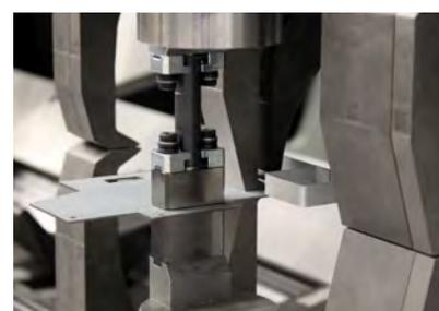
Entlang der Biegelinie lassen sich mehrere Biegestationen aufbauen. Komplexe Biegeteile werden dadurch in einem Durchlauf fertiggestellt.
