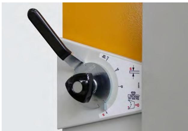
Hebel für die Schnittspaltverstellung an der PRIMEcut.
