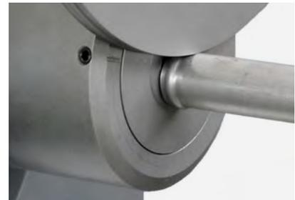
Schlauchsicke für Hydraulikrohre
