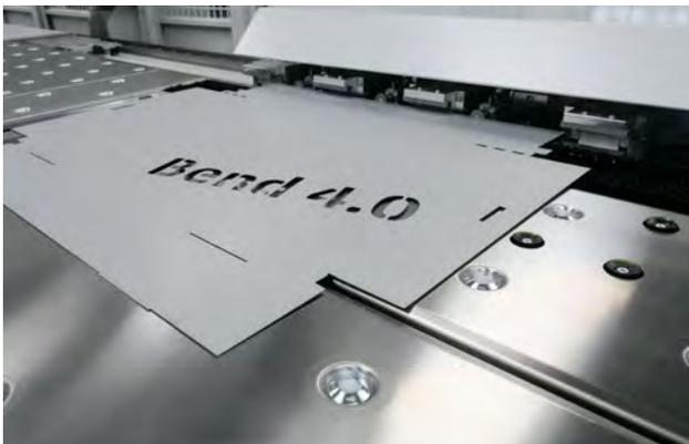
Manuelles Beladen der Platinen und manuelle Entnahme der Biegeteile
