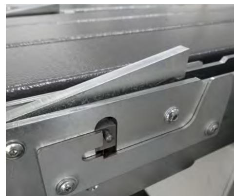
Bei nicht geraden Außenkanten der Platinen lassen sich einzelne Anschlagfinger inaktiv schalten.
