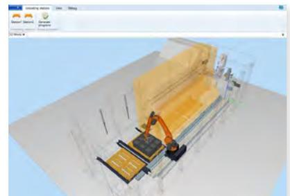
Die Generierung der optimalen Stapel-Routine eines Fertigerteils auf der Palette erfolgt durch das RASpall-Programm.
