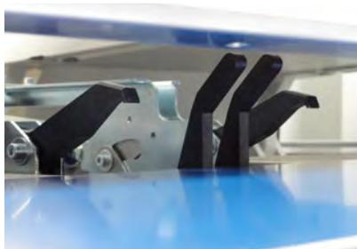
Gesicherte Biegequalität durch automatisches Ausrichten der Zuschnitte.
