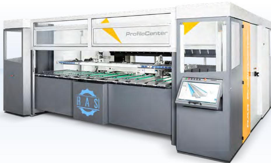
Das ProfileCenter biegt Profile wie etwa Tüorzargen, Fensterzargen, Aufzugsportale, Schaltschrankkomponenten und Kabelkanäle in Losgröße 1. Das einzigartige FlexGripper-Handlingssystem positioniert, dreht und wendet das Biegeteil automatisch während des Biegeablaufs.
