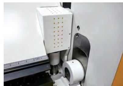
Die PowerBooster spannen die Bleche mit 120 Tonnen Spannkraft und sichern gerade Biegungen.
