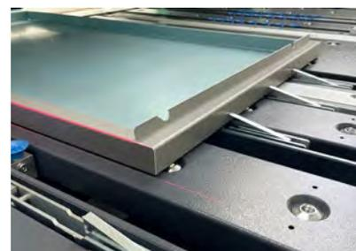
Saugerleisten neben den Anschlageinheiten halten das Biegeteil für Folgebiegungen an den Anschlagfingern.
