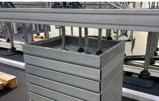
Beladesystem zum automatischen Zuführen der Platinen von einem Blechstapel mit sortenrein und kantengenau gestapelten Blechen
