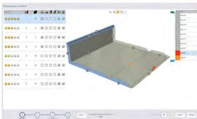
Die Bendex-Software kann das Biegeteil als STEP, dxf oder geo-Datei importieren. Die Software programmiert automatisch mögliche Biegeabläufe und bewertet sie mit einem 5-Sterne-Ranking.
