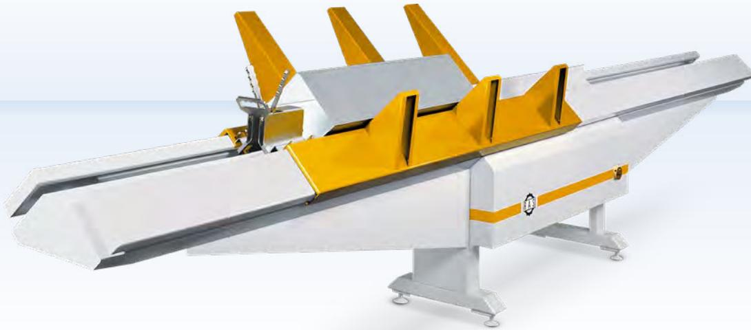
Der RAS DuctZipper-V formt und schließt die Falzverbindung an kleineren und mittelgroßen Luftkanälen. Lufttechnische Profiqualität lässt sich kaum schneller, leichter und wirtschaftlicher herzustellen. Der RAS DuctZipper schließt vorab gebogenen Luftkanal in einem einzigen simplen Durchlauf.
