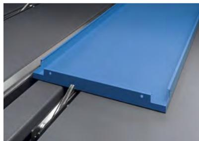
Lange, schmale Biegeteile am Winkelanschlag ausgerichtet.
