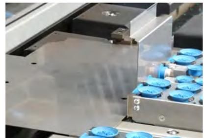
Hohe Flexibilität beim Handling durch Frontsauger und Kleinteilesauger.
