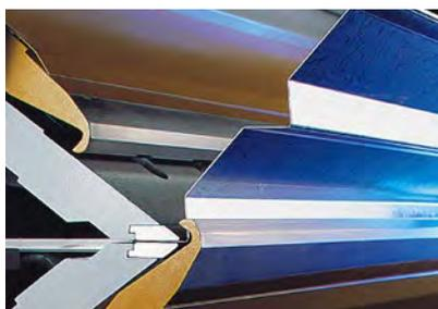
Kein Wenden der Biegeteile erforderlich, da die Maschine nach oben und unten biegt. Hohe Produktivität durch schnelle Biegeabläufe.
