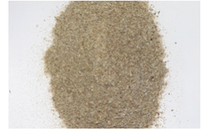
Stroh Standard Edelstahlrotor Weich Aufgabengröße muss kleiner als 80 mm und trocken sein
