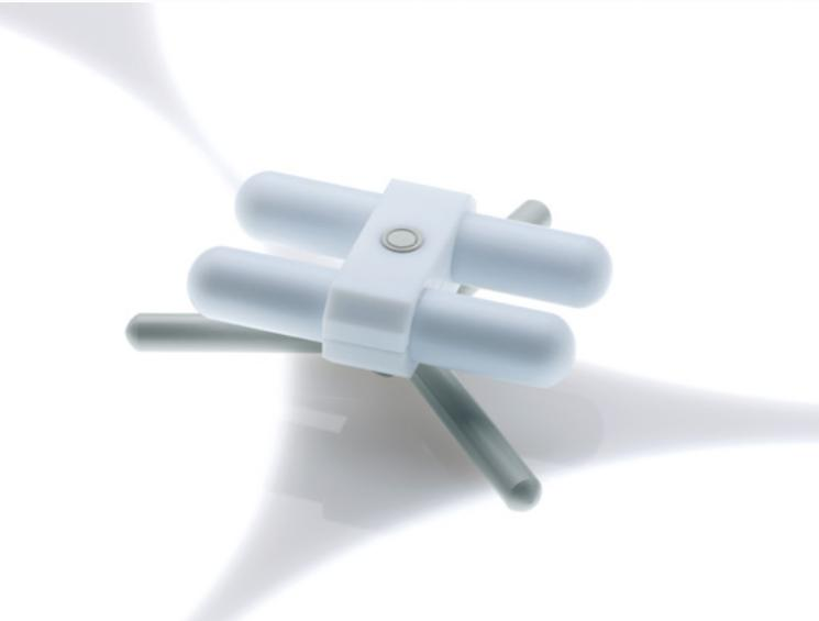
Hocheffektiver, auf Dreibein-Konstruktion gelagerter Doppel-Rührstab aus abriebfestem PTFE, besonders geeignet für große Volumina, viskose Medien in Edelstahlbehältern und dem Einsatz mit abrasiven Stoffen, wie z.B. Sand oder Feststoffen im Medium.
