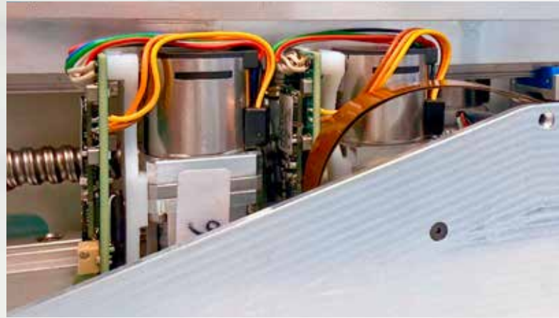
Die kompakten, leistungsstarken bürstenlosen DC-Flachmotoren der BXT-Familie inklusive Encoder IEF3 sind die ideale Wahl für die Integration in den begrenzten Bauraum.
