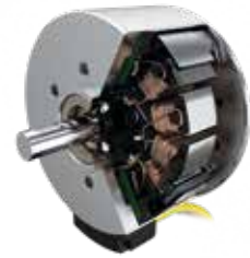
Die innovative Wickeltechnik der eisenbehafteten BXT-Motoren verfügt über einen hohen Kupferfüllfaktor bei gleichzeitig geringem Platzverbrauch.
