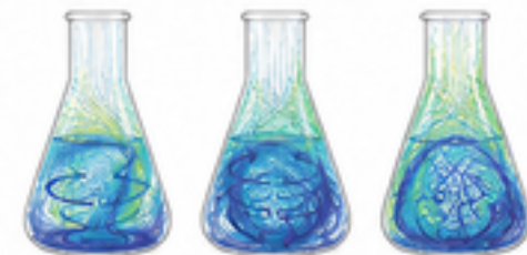
Niedrige Drehzahl (schlechte Durchmischung) | Optimale Drehzahl (homogene Durchmischung) | Zu hohe Drehzahl (turbulente Strömung)
