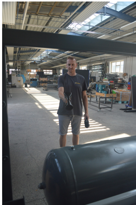
Mit dem Schalltrichter des UY000003 wird der Vakuumkessel der Membranpresse auf Undichtigkeiten untersucht.
