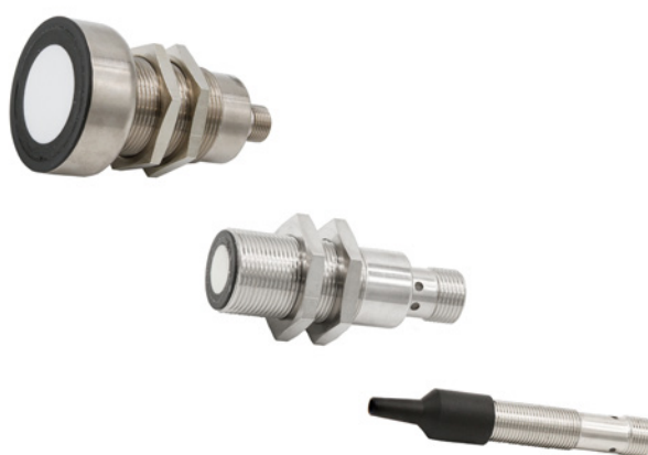
Ultraschallsensoren von ipf electronic, darunter ein Gerät mit einem Schallreduzieraufsatz (unten) zur Fokussierung der Schallkeule für Messungen durch kleinste Öffnungen.
