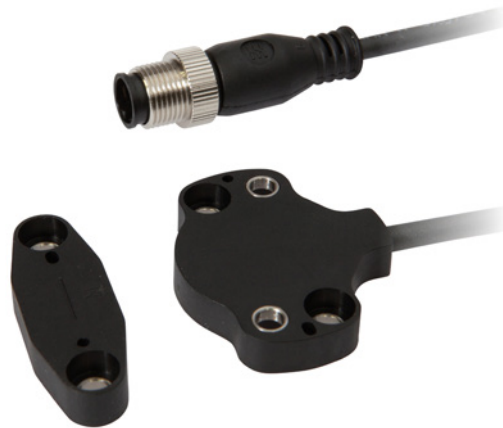
Die Winkelsensoren der Reihe MD42002x bestehen aus einem beweglichen Geber (links) und einem stationären Sensor (rechts) mit M12-Stecker.
