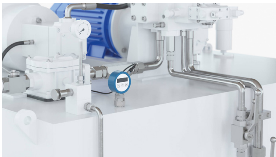
Niveauabfrage mit einem Sensor der Reihe FM91x an einem Vorratsbehälter für Hydrauliköl.
