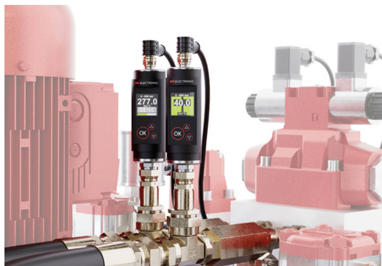
Drucksensoren der Reihe DW5x an einem Hydraulikaggregat. Nach der Montage lässt sich das Display in 90-Grad-Schritten drehen, um es in jeder Einbaulage einfach ablesen zu können. Auch das Sensorgehäuse ist stufenlos um 305 Grad drehbar.
