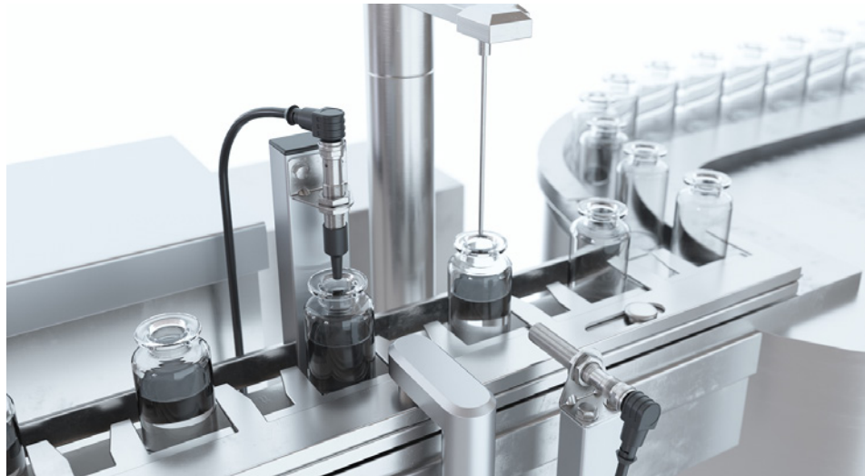
Der Ultraschallsensor UT129021 mit Schalldüse (links) erfasst den Füllstand in den Flaschen. Um sicherzustellen, dass für die Dosierung stets eine Flasche bereitsteht, befindet sich an der Dosierstation noch der Ultraschallsensor UT129520 (rechts) mit digitalem Schaltausgang zur Anwesenheitskontrolle.
