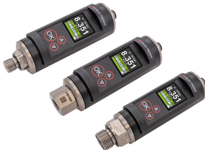
DW50 mit 1/4-Zoll-Außengewinde (oben), DW51 mit 1/4-Zoll-Innengewinde (Mitte) und DW52 mit 1/2-Zoll-Außengewinde und frontbündiger Membran (unten).
