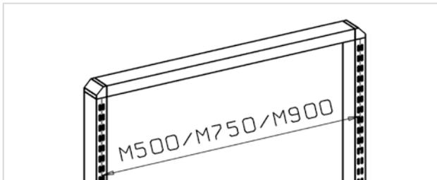
Die Modulgröße (M) bezieht sich auf den Abstand zwischen zwei Rasterrohren, von der Mitte des Rohres aus gemessen. Sie dient zur Identifizierung des geeigneten Zubehörs.
