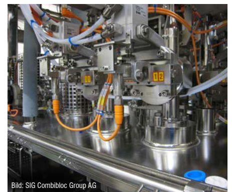
Ventilhubmessung in der Lebensmittelindustrie Ideal für die Lebensmittelindustrie sind die dichten Edelstahlgehäuse der Baureihen MDS-45-Mxx.
