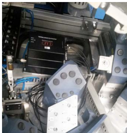
Farb- und Intensitätsprüfung von Fahrzeugleuchten.
