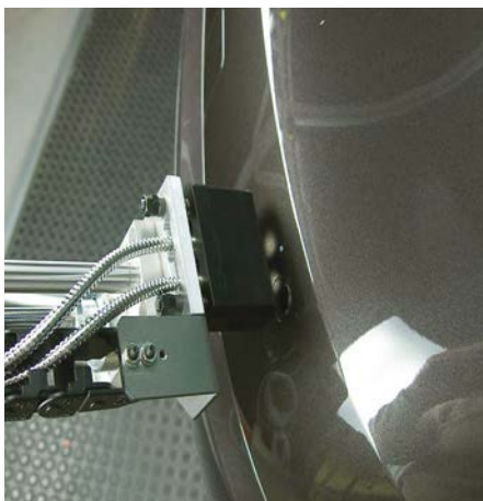
Kontrolle der Farbgleichheit bei Anbauteilen in der Automobilfertigung.
