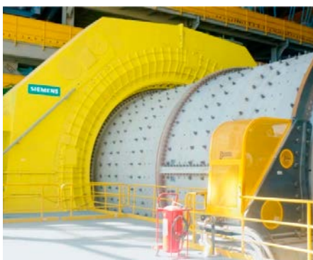
Kapazitive Sensoren werden unter anderem zur Luftspaltmessung in großen Elektromotoren eingesetzt.
