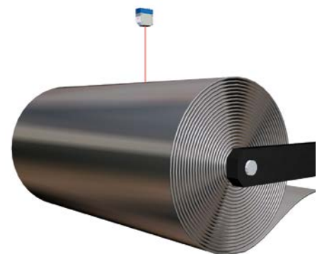
Erfassung von Coildurchmessern Über die Erfassung von Coildurchmessern durch Lasertaster wird die auf- bzw. abgewickelte Stahlmenge überwacht.
