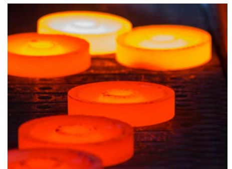
Temperaturmessung in der Metallindustrie Temperaturüberwachung beim Auskühlen von geschmiedeten Teilen mit CTLaser M1.
