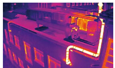
Temperaturüberwachung in der Gebäudethermografie
