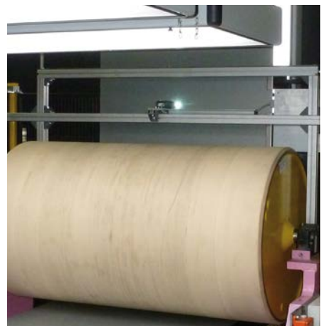
Farbmessung von Endlosband-Beschichtung wie Aluminium, Zink und Papier im Produktionsbetrieb.
