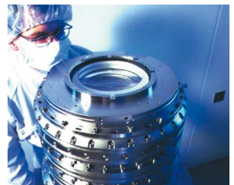
Berührungslose kapazitive Wegsensoren werden zur nanometergenauen Justage von Linsen in Objektiven für die Waferbelichtung eingesetzt.
