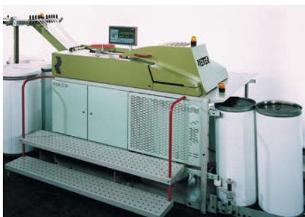
Anwendungsbeispiel Maschinenüberwachung Wirbelstromsensoren überwachen die Dicken-schwankungen von Garnen in Textilmaschinen.
