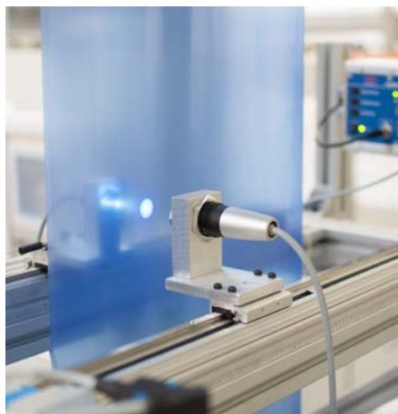
Inline Farbmessung des Farbverlaufes von transparenten Folien und Acryl-Gläsern.
