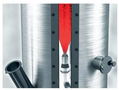
**Bild 4** Im Synthesereaktor pulsiert in der speziell konstruierten Reaktionskammer nur der kontrollierte Gasstrom; zur Partikelherstellung werden feine Tröpfchen einer Rohstofflösung in den Gasstrom gesprüht
