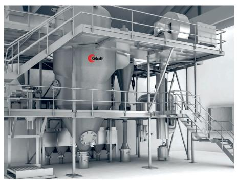
Bild 8 ProAPP® 500 Anlage zur Herstellung von Hochleistungspulvern
