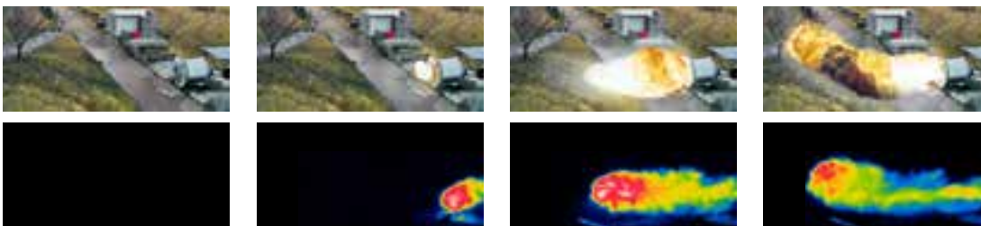
Aufzeichnung einer Staubexplosion, konventionell entlastet mit einer Berstscheibe.
