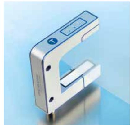
*Ultraschallbahnkantensensoren tasten die Kanten von schallundurchlässigen Materialien wie z.B. Folien oder Papier ab. Sie eignen sich besonders zur Bahnlauf-Regelung von hochtransparenten Folien, lichtempfindlichen Materialien oder Materialien mit stark wechselnder Transparenz.*
