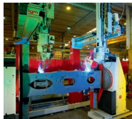
Einer der Fertigungsprozesse nach dem Richten ist das autogene Roboter-Schweißen. Gerichtete Teile sorgen für einen konstanten Schweißspalt, und Vorrichtungen können vereinfacht werden, da gerichtetes Material beim Schweißen nur in geringem Umfang Spannungen freigt. Bild: Liebherr-Hydraulikbagger GmbH
