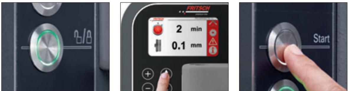
Besonders einfach: Mahlkammer verriegeln, Mahlparameter einstellen, Mahlvorgang starten – fertig.
