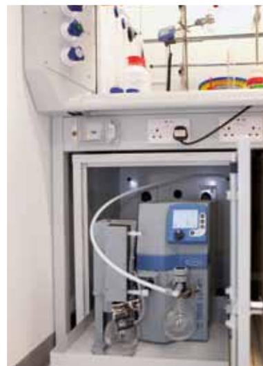
Chemie-Netzwerkpumpstand unter dem Abzug, mit Lösemittelrückgewinnung
