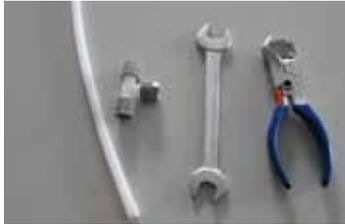
Werkzeug zur VACUU·LAN®-Installation
