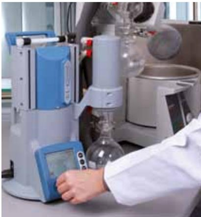
Einzelplatzversorgung: Grobvakuum mit einem chemiebeständigen Pumpstand am Rotationsverdampfer
