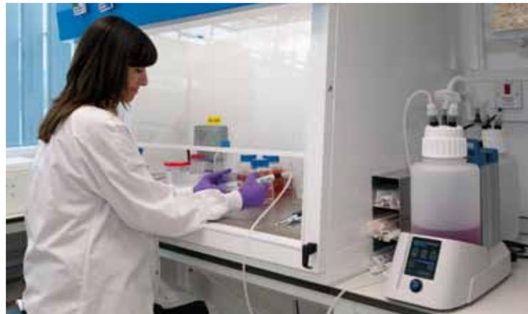
Einzelplatzversorgung: Grobvakuum, Flüssigkeitsabsaugung
