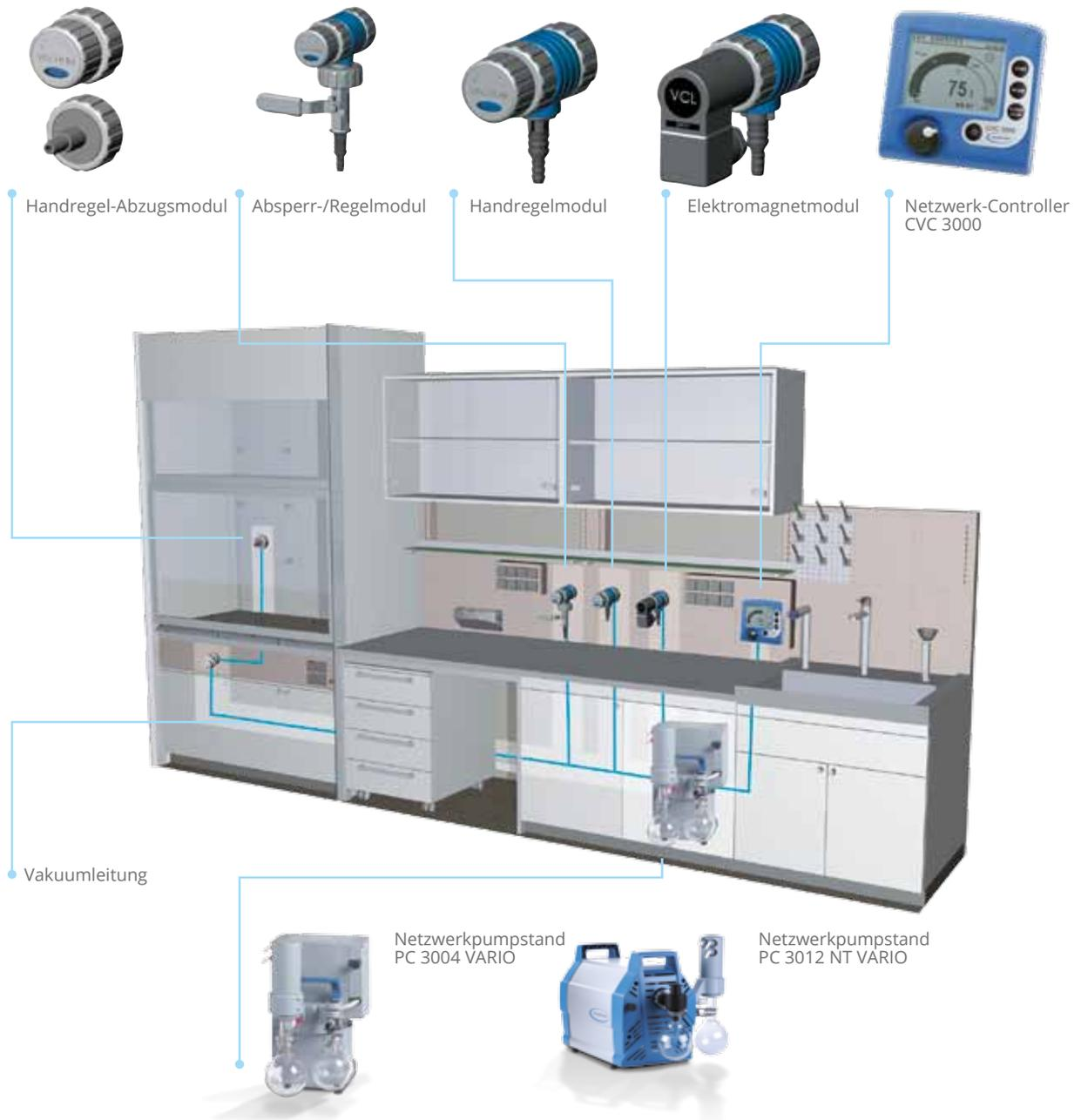
Schematische Darstellung einer VACUU-LAN® Installation
