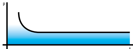
Abb. 17: Punktgenaue Regelung durch Drehzahlsteuerung
