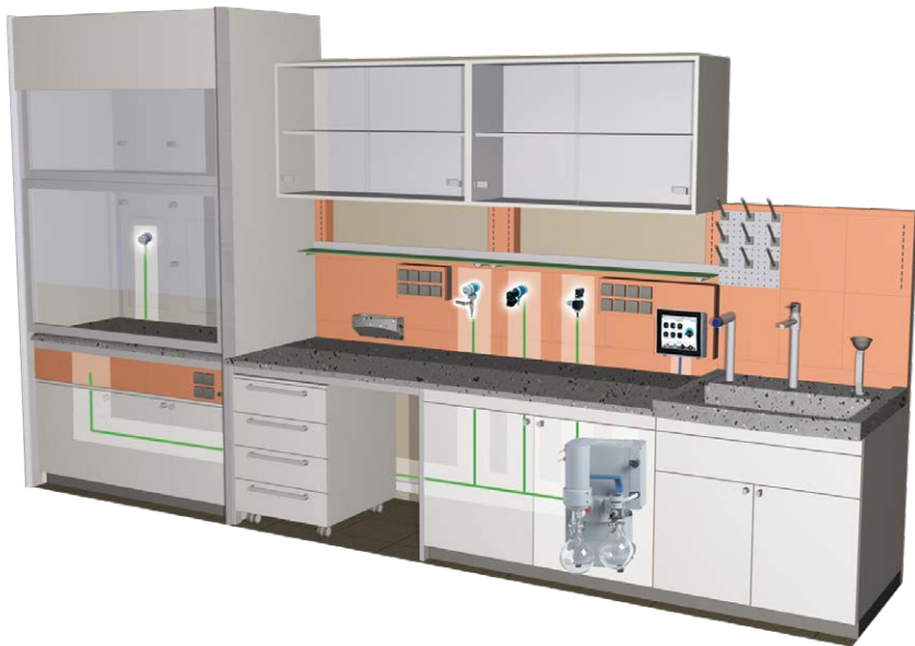
Abb. 20: Lokales Netzwerk VACUU-LAN®. Eine Pumpe im Unterschrank versorgt mehrere Arbeitsplätze.
