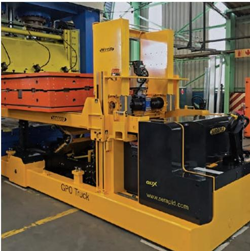
WERKZEUGTRANSPORT- UND -POSITIONIERSYSTEM AN METALLPRESSEN
