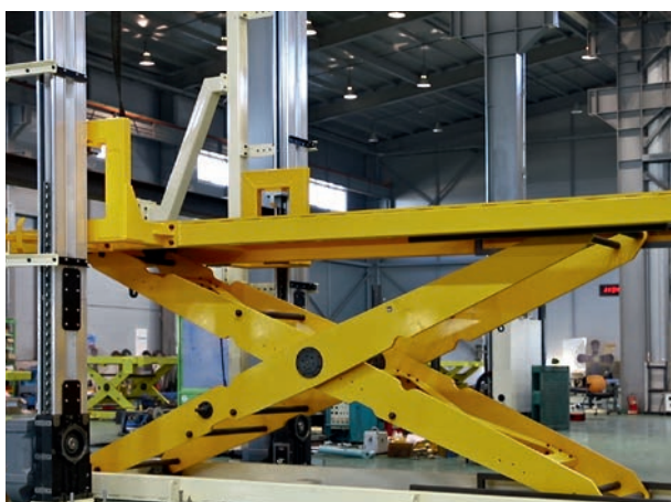
Hubtisch mit seitlichen VLB-Aktuatoren, GM Korea
