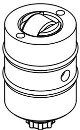
Der Zentriering an der Oberseite der Rolleneinsatzbuchse ist nach der Installation auszurichten.
