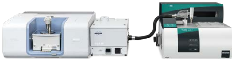
TG-FT-IR-Kopplung über eine externe FT-IR-Gaszelle
