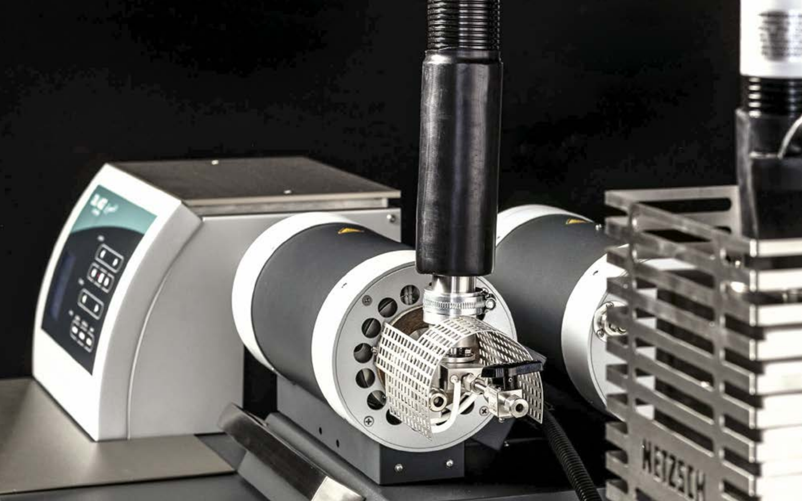
Siliziumcarbid-Ofen mit angeschlossener Transferleitung für die Emissionsgasanalyse
