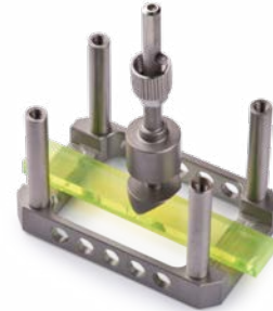
Probenhalter für Messungen in 3-Punkt-Biegung
