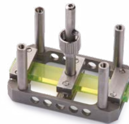
Probenhalter für Messungen in ein-/zweiarmiger Biegung
