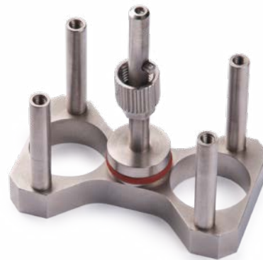
Probenhalter für Messungen im Kompressionsmodus
