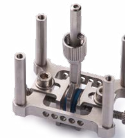
Probenhalter für Messungen im Schermodus
