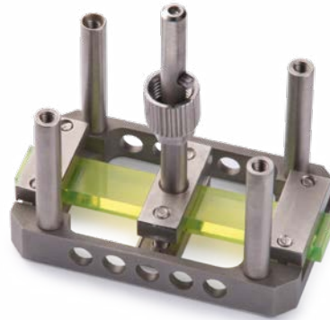
Probenhalter für zweiarmige Biegung
