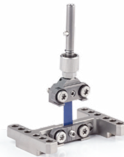
Probenhalter für Messungen im Zugmodus
