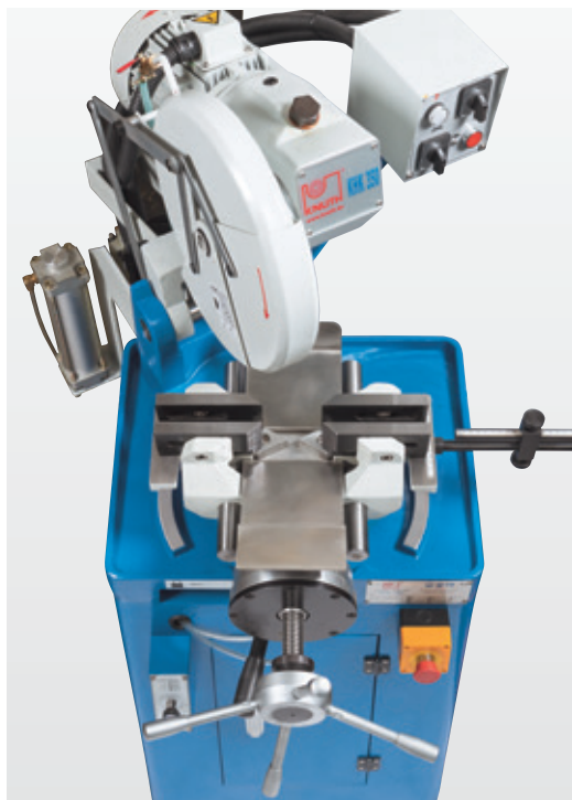
Pneumatischer, zentrisch spannender Schraubstock
