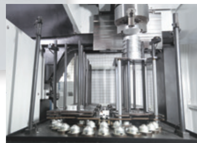
Werkstückspeicher mit 8 Stationen
