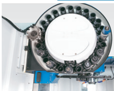
Werkzeugwechsler mit Doppelarmgreifer
